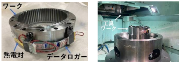
Fig.7 温度測定システムと実験系の概観
