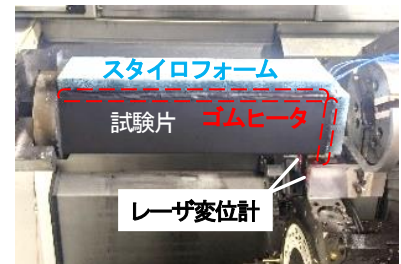
Fig.5 熱変位測定実験
