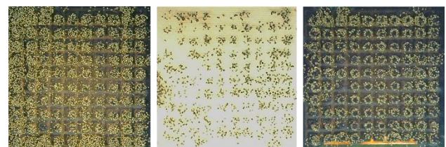
図 8 粘着固定した金属粒子の剥離
