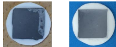
図6 接着促進剤の使用による接着向上
