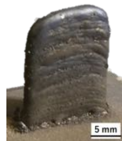
図2 傾斜機能材料の造形物
