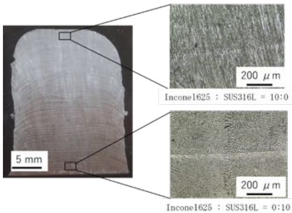
図7 傾斜機能材料の金属組織
