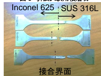
図 4 破断後の引張試験片
